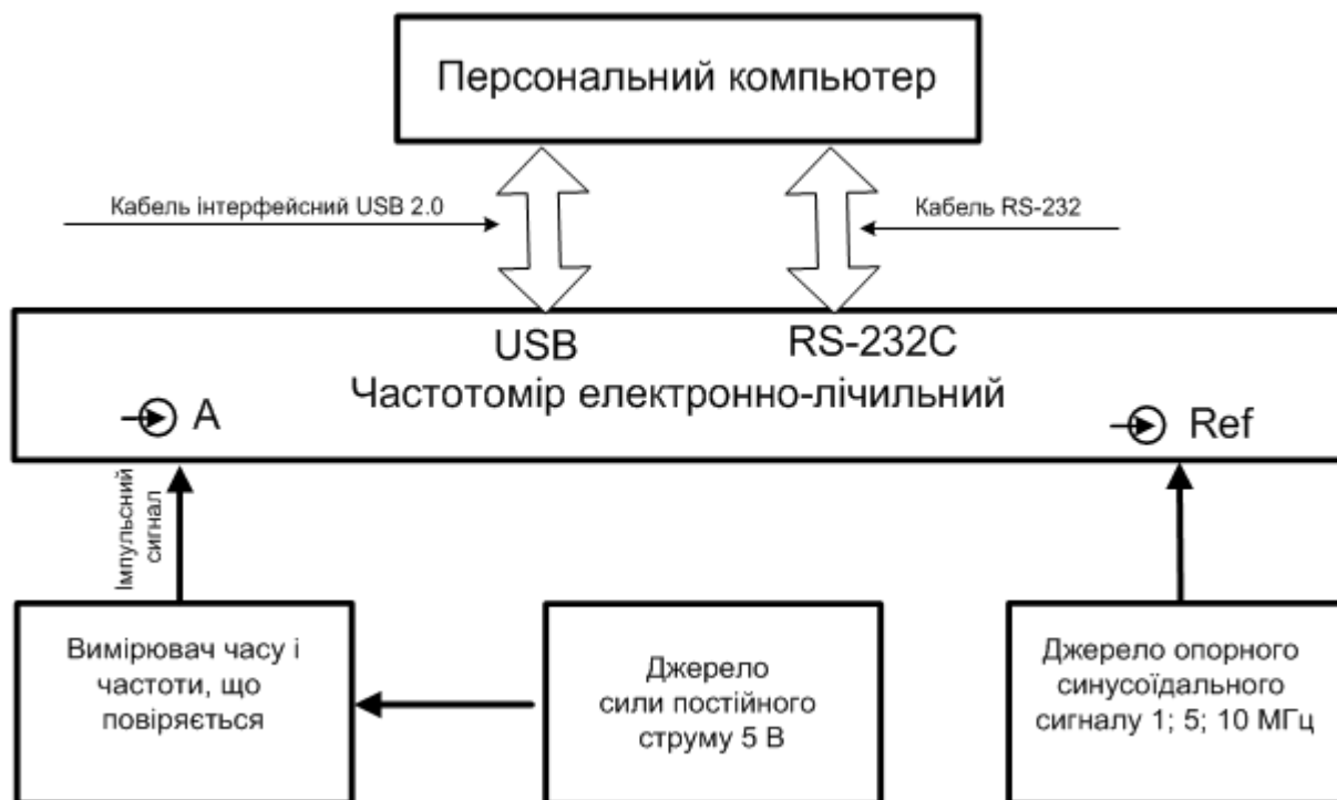
Рисунок Б.2 Схема підключення з використанням джерела сили постійного струму для зовнішнього запуску ВЧЧ
