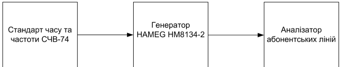
Рисунок Б.1 - Схема з'єднання ЗВТ для визначення відносної похибки вимірювання частоти
