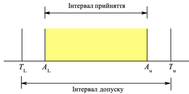
Рисунок 1 - Бінарна оцінка відповідності, де рішення приймаються на основі вимірних значень величини. Істинне значення вимірної властивості (вимірюваної величини) повинно знаходитись в інтервалі допуску, визначеного границями ( T_L , T_U ). Об'єкт приймається як відповідний, якщо вимірне значення властивості лежить в інтервалі, визначеному границями прийняття (див. 3.3.8) ( A_L , A_U ), а в іншому випадку відхиляється як невідповідний.
