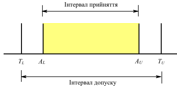
Рисунок 12. Бінарна оцінка відповідності, де рішення базуються на значеннях вимірюваної величини. Істинне значення вимірюваної властивості (вимірюваної величини) об'єкту задається в інтервалі, який визначається границями ( T_L , T_U ). Об'єкт приймається як відповідний, якщо вимірюване значення властивості знаходиться в інтервалі прийняття, який визначається границями ( A_L , A_U ) або іншому випадку відхиляється як невідповідний.
