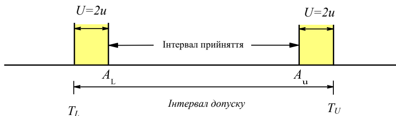
Рисунок 10. Двосторонній інтервал прийняття, створений шляхом зменшення інтервалу допуску на обох сторонах через k = 2 розширену непевність U = 2u . Це – прийняття рішення за замовчуванням, встановлене в ISO 14253-1 [21].
